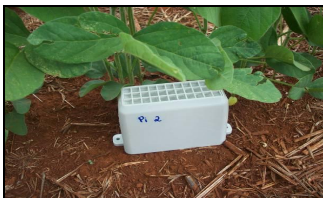
Figura 2: Instrumento pluviométrico utilizado para coleta de dados da Pi.
