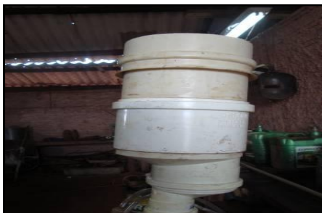
Figura 3: Instrumento pluviométrico utilizado para coleta de dados da Ps e Pe.
