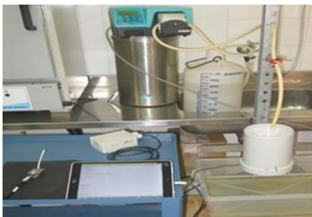
Figura 10. Calibração do Pluviômetro, Resolução nominal = 0,45 mm e Resolução média = 0,49 mm
