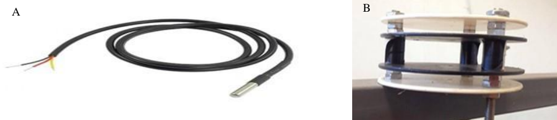
Figura 2. Sensor de temperatura utilizado no experimento Acurácia \pm 0,5^{\circ}\text{C} para medições entre 10^{\circ}\text{C} e 85^{\circ}\text{C} e abrigo do sensor de temperatura.
