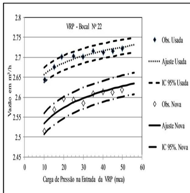
**Figura 1.** Curva carga de pressão- vazão de um conjunto PSR10 i-Wob com bocal de número 22 com duas categorias de VRP: Usada (marcas cheias) e Nova (marcas vazias).
