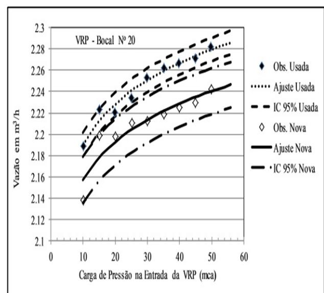
**Figura 2** Curva carga de pressão- vazão de um conjunto PSR10 i-Wob com bocal de número 20 com duas categorias de VRP: Usada (marcas cheias) e Nova (marcas vazias).
