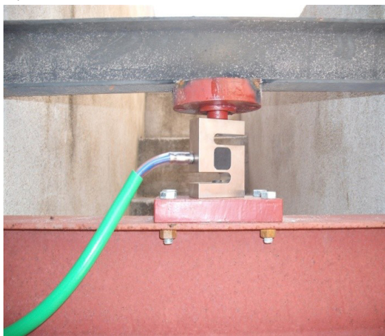
Figura 3. Cantoneiras para fixação das células de carga (A) instalação das células carga (B).
